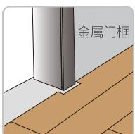
**金属门框**——在地板上标出金属门框的尺寸，然后锯切掉标记部分，再将地板安装到位。
