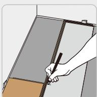
安装最后一片地板时，将地板面朝下，标记出需要锯切的位置，沿着标记锯切地板，将没有锁扣的短边朝墙安装。（如果墙面不平整，地板必须按照墙的轮廓线调整。拆开第一行，根据需要锯切地板，再和已到位的地板紧密扣合。）
