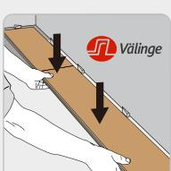
将第二块地板的短边成斜角滑入第一块地板短边的 **Välinge** 锁扣系统，然后垂直下压扣合；安装三片地板后，将地板长边推至墙边，预留出8~10mm的伸缩缝。
